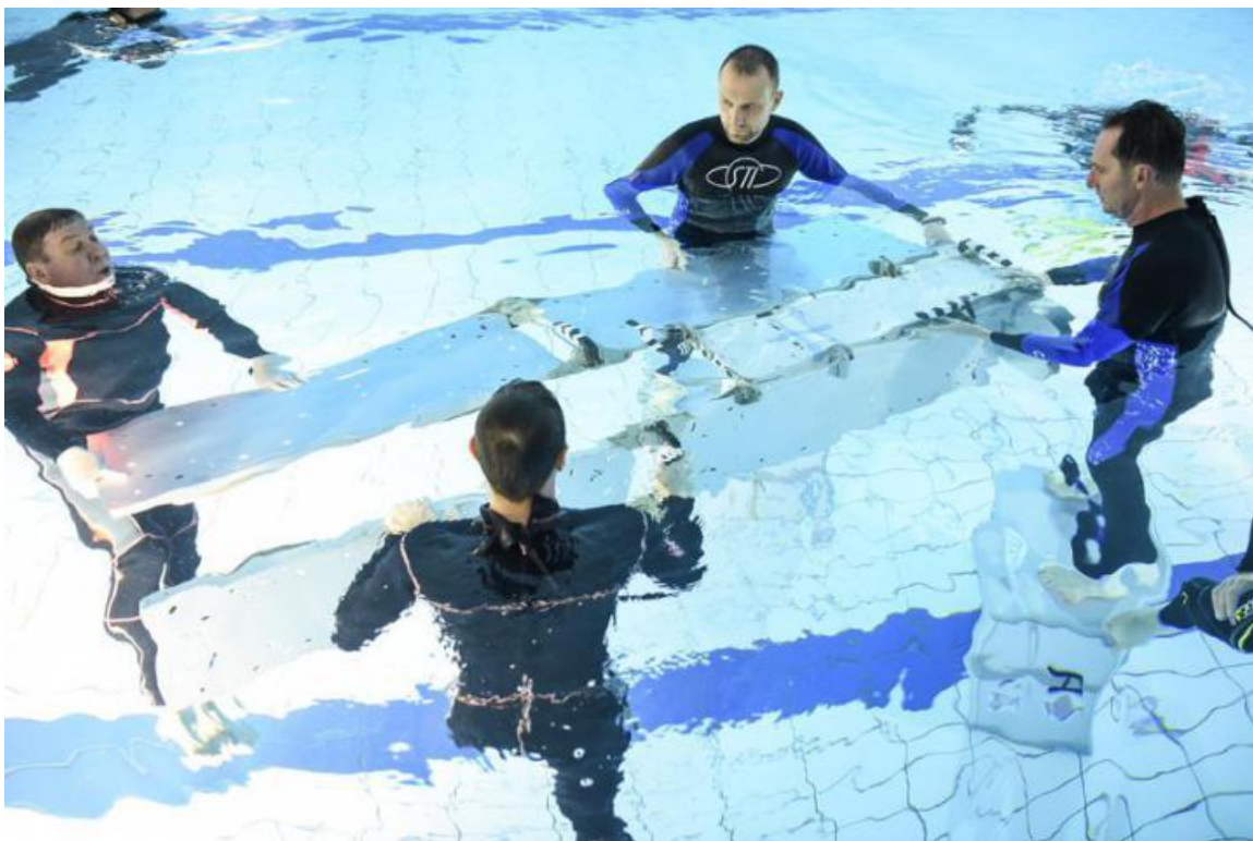
Ingenieure entfalten in der Therme in Konstanz das Flugmodell der Icarus-Antenne, das unter Wasser schwimmt. | Bild: Felix Kästle (dpa)
